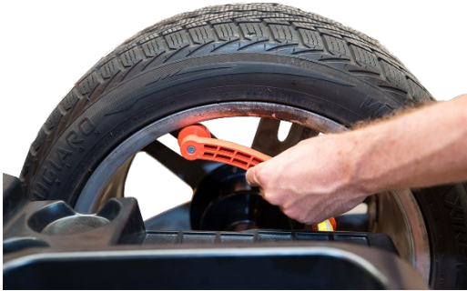
1. Meetinstrument voor velgdiameter en afstand wiel-machine
